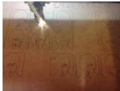
2- Corte laser sobre MDF
